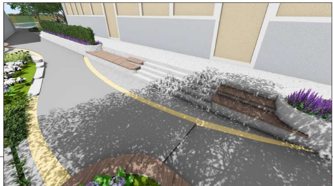
Posedové schodiště jako náhrada stávajícího zábradlí.
