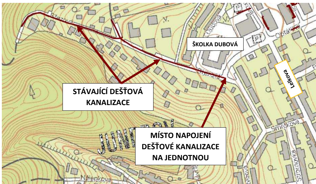
Vedení stávající dešťové kanalizace (BKOM)
